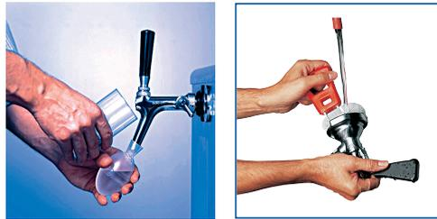
Bewährt hat sich ein chemisch-mechanisches Reinigungsverfahren. Die Reinigung und Desinfektion ist von demjenigen zu beschreiben, der die Reinigung durchgeführt hat (z. B. Betreiber oder Fachfirma). Die Dokumentation der Reinigung und Desinfektion ist an der Betriebsstätte zu hinterlegen.
