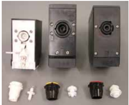
Abb. 5: Zerlegte Zapfhähne (Bier, Postmix) zur gründlichen Reinigung
