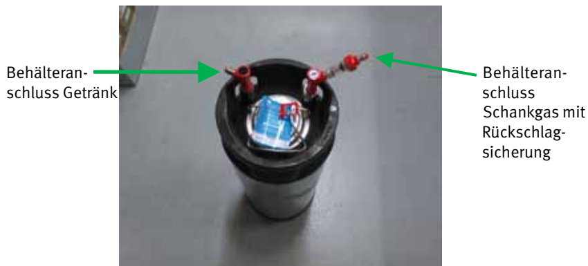
Abb. 15: Beispielhafter Anschluss mittels Steckverbindungen (Kupplungen)
